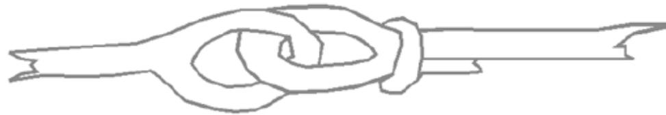
Figura 3. 9. Cadena empleada en el puente atirantado Dryburgh Abbey en 1817
