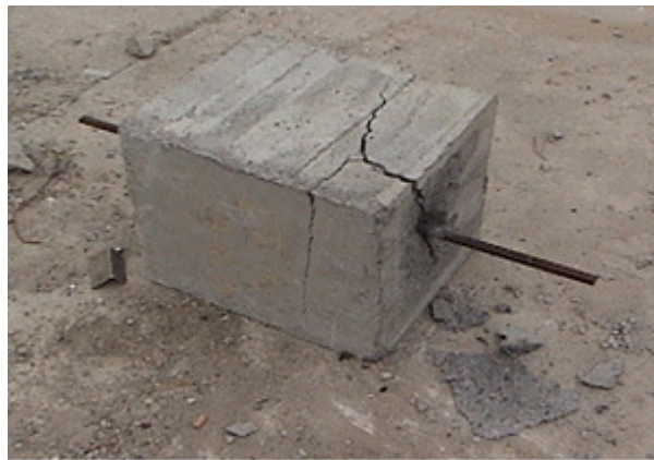
Foto 13. Prototipo fallado ensayado a tensión
