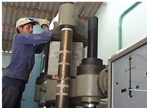
Foto 14. Montaje prototipo ensayo a tensión
